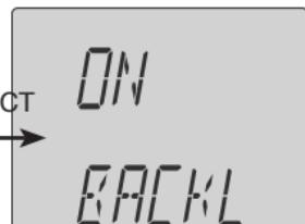
Die Hintergrundbeleuchtung kann auf «ONOFF», «ON» oder «OFF» gesetzt werden. «ONOFF» aktiviert die automatische Ausschaltfunktion, welche die Hintergrundbeleuchtung bei Berührung aktiviert und 10 Sekunden nach der letzten Tastenbetätigung ausschaltet.
