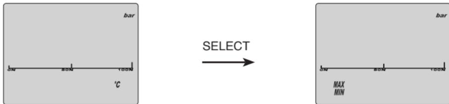
Wechselt zwischen der Temperatur-Anzeige und der Min./Max. Druck-Anzeige im unteren Teil des Displays.
